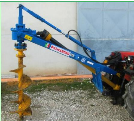
Trivella TFI con 3° punto idraulico
